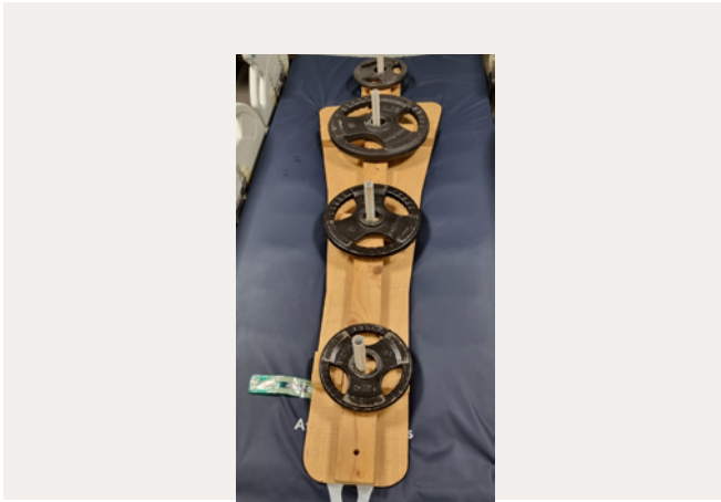
図 20: 圧切替型体圧再分配 50 パーセンタイルマネキン試験の設定 (説明目的専用)
